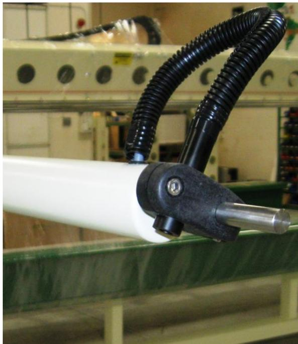
**La linea laser** La linea laser consentirà all'operatore di allineare rapidamente i nuovi rotoli. La linea laser è la linea centrale del macchinario, dalla quale vengono effettuate tutte le misurazioni.
