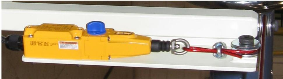
**Stop con tiraggio a corda** Interromperà l'energia a ogni parte semovente del macchinario. Una volta che il tiraggio a corda è stato tirato, dovrete riavviare il sistema riportando il bottone blu verso la freccia rivolta in avanti.
