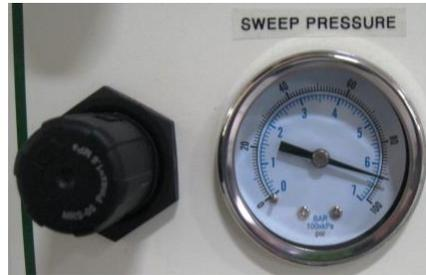
**Regolatore di pressione del sistema di pulizia a spazzata** Aumenterà e diminuirà la pressione del sistema di pulizia a spazzata. Per aumentare la pressione girate il pomello in direzione oraria, mentre per diminuirla giratelo in direzione antioraria. Quando volete diminuire la pressione, è consigliato portare la pressione a zero e successivamente aumentarla alla pressione desiderata.
