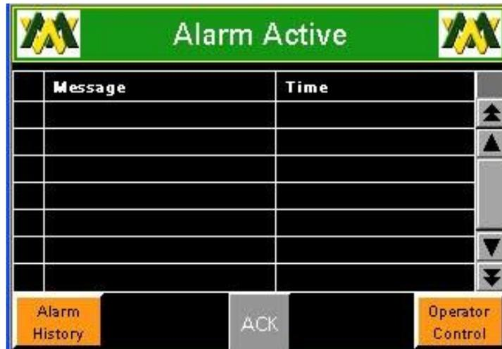
**Alarm Screen.** Mostra qualsiasi allarme che può essersi verificato. Il bottone dice al macchinario che avete riconosciuto il problema e che i necessari aggiustamenti sono stati compiuti. Dovete premere il botto *ACK* per continuare a lavorare.
