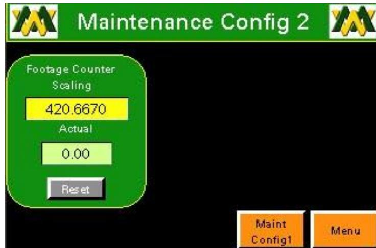
**Footage counter scaling** Aumenterà o diminuirà la lunghezza del materiale. Si raccomanda di contattare Miller Weldmaster prima di effettuare una qualsiasi regolazione al fattore di scala.
