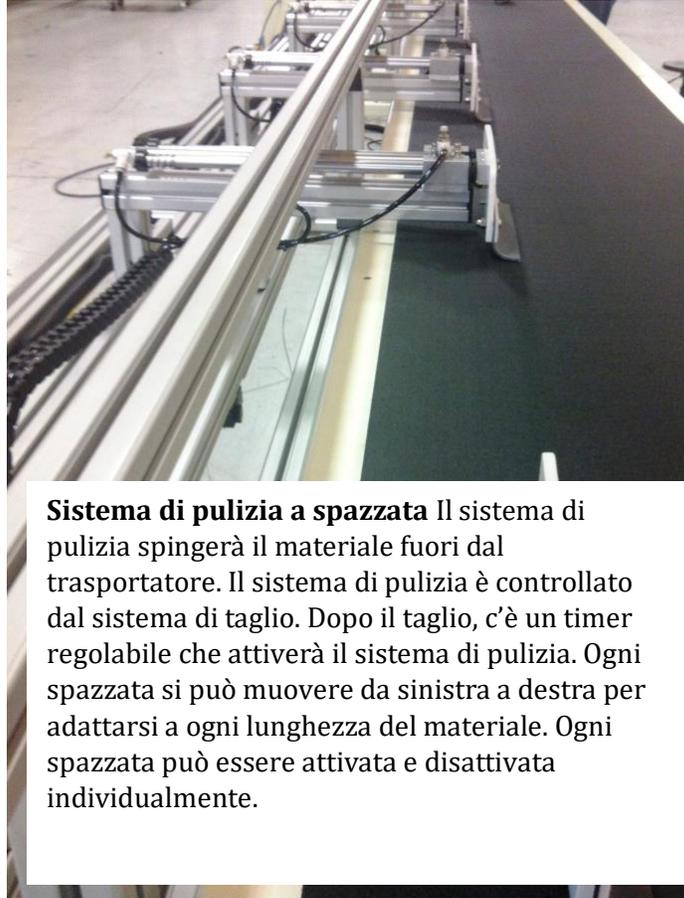
**Sistema di pulizia a spazzata** Il sistema di pulizia spingerà il materiale fuori dal trasportatore. Il sistema di pulizia è controllato dal sistema di taglio. Dopo il taglio, c'è un timer regolabile che attiverà il sistema di pulizia. Ogni spazzata si può muovere da sinistra a destra per adattarsi a ogni lunghezza del materiale. Ogni spazzata può essere attivata e disattivata individualmente.
