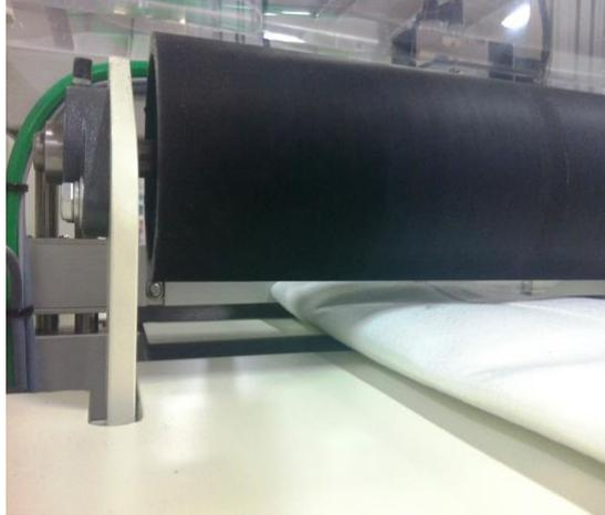
**Rullo estrattore del nastro trasportatore** Il rullo estrattore estrarrà dall'accumulatore. La velocità dell'estrattore è determinata dalla posizione dell'accumulatore. Il bottone aperto/chiuso è posizionato sullo schermo HMI.
