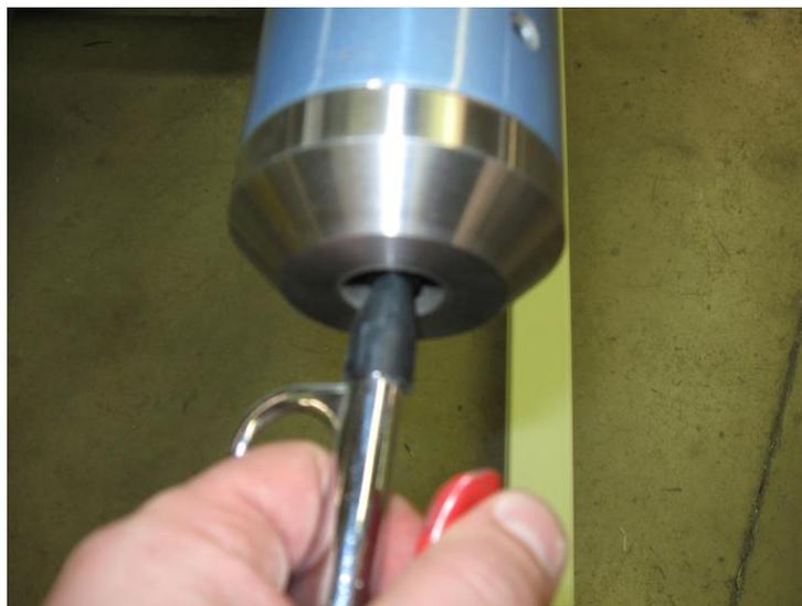
**Aerare il condotto** Il condotto deve avere aria al suo interno per mantenere il rotolo di materiale in posizione. La figura qui sopra mostra dove fate ventilare il condotto e rilasciate l'aria. Posizionate il bocchettone dell'aria nella valvola del condotto per pompare l'aria. Per sgonfiare il condotto dell'aria, trattenete la valvola finché l'aria non viene rilasciata.
