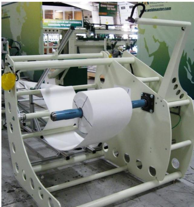
**Stand per svolgitore di bobine** Lo stand per svolgitore di bobine conterrà il rotolo di materiale. Il macchinario scarica tensione. Lo stand tratterrà la tensione mentre il macchinario è in funzione. La tensione è controllata dai cilindri di tensione connessi alle celle di carico.
