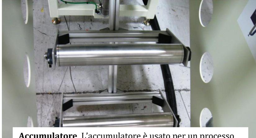
**Accumulatore.** L'accumulatore è usato per un processo costante. Mentre il materiale viene tagliato, l'accumulatore prenderà in carico il lavoro del macchinario, così che il macchinario non debba interrompere il processo di saldatura.
