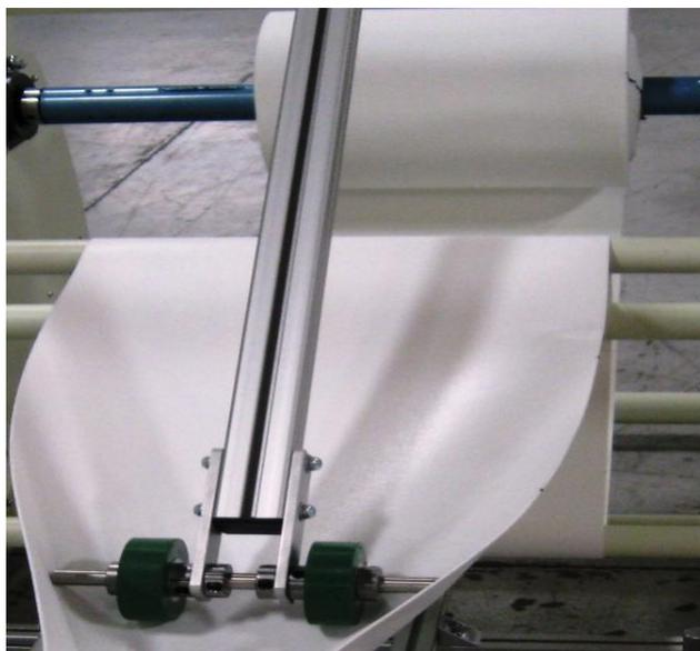
**Rullo di discesa** Il rullo di discesa darà inizio al processo di piegatura del tubo. Il rullo è regolabile a differenti ampiezze. Il rullo in discesa si regolerà per appiattire i tubi.
